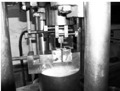
Рис. 1. Изгиб образцов на УИМ 50М (по ГОСТ 14019)
