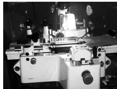
Рис. 2. Замеры образцов с помощью инструментального микроскопа БМИ
