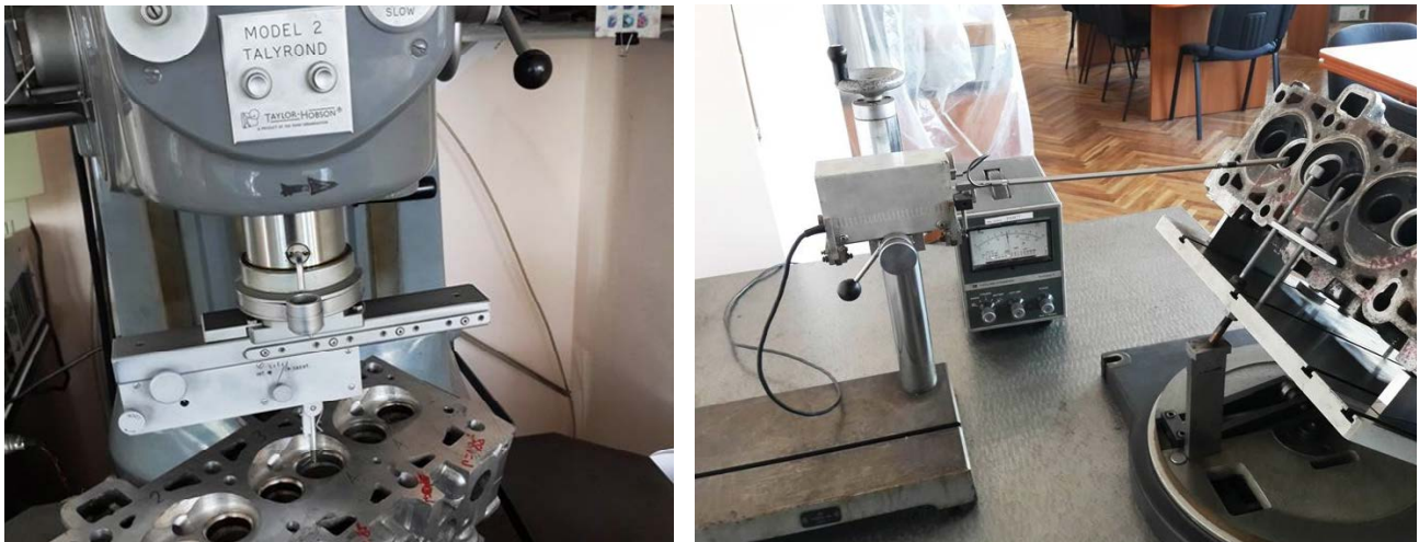
Рис. 4. Контроль параметров качества обработанных сѐдел клапанов: (а) – измерение отклонения от круглости на кругломере Talyrond, Model 2; (б) – измерение шероховатости на профилометре Taylor Hobson, Surtronic 2
