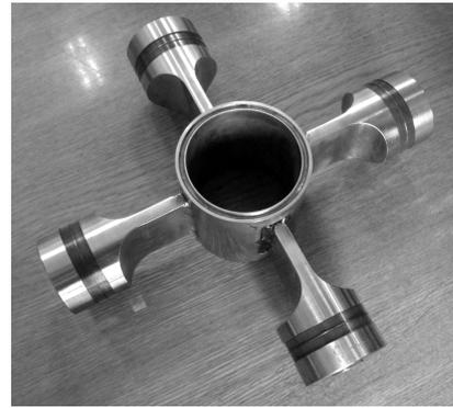
**Рис.3. Секция ультразвукового проточного кольцевого вибратора радиальных колебаний**
