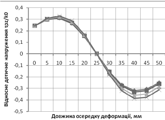
Рис. 3. Розподіл відносного дотичного напруження при факторі форми S/h=5 ; коефіцієнті тертя f=0,5 ; \xi = 1 \dots 1,25 ; \xi_0 = 1
