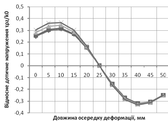
Рис. 5. Розподіл відносного дотичного напруження при факторі форми S/h=5 ; коефіцієнті тертя f=0,5 ; \xi_1 = 1 ; \xi_0 = 1 \dots 1,25
