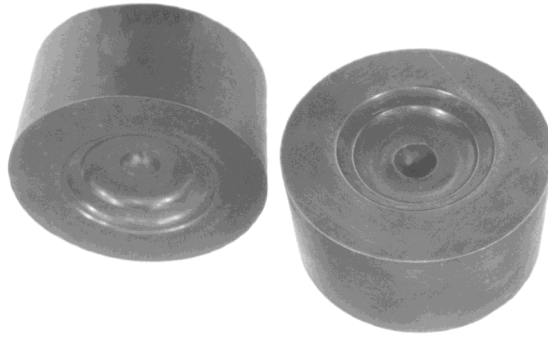
Рис. 11. Заготовки порожнин матриць із сталі Р6М5, які отримані видавлюванням
