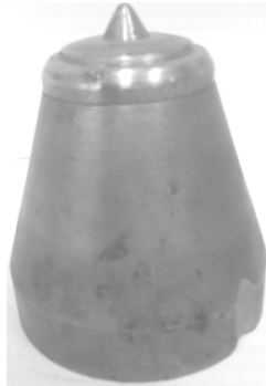
Рис. 10. Деформуючий пуансон для видавлювання порожнин
