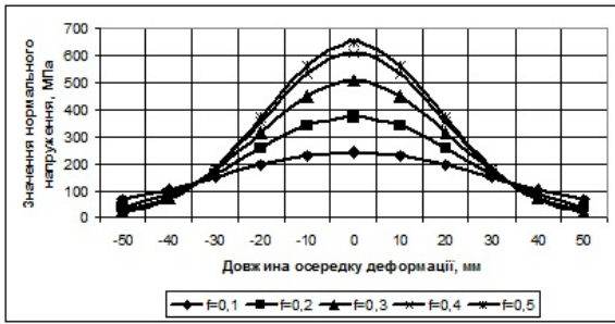
Рис. 1. Значення нормального напруження по довжині осередку деформації (при z = h/2 ) для осадки при різних значеннях коефіцієнта тертя T = 1100, U = 8, d/h = 10, \varepsilon = 0.2
