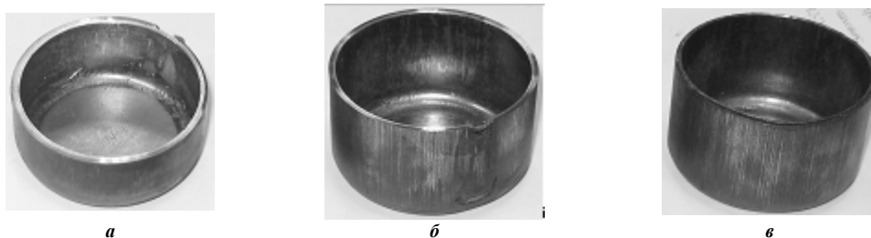
Рис. 8. Двошарові елементи системи Титан- Al: а – перший перехід без потоншення; б та в – другий та третій переходи з потоншенням
