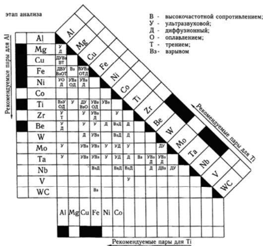
Рис. 5. Процес вибору додаткового проміжного шару
