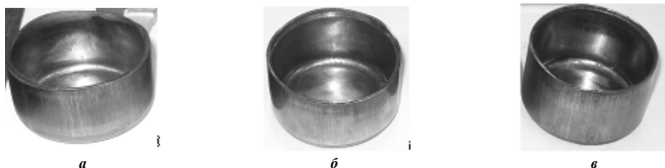
Рис. 9. Двошарові елементи системи Латунь- Сталь: а – перший перехід без потоншення; б та в – другий та третій переходи з потоншенням
