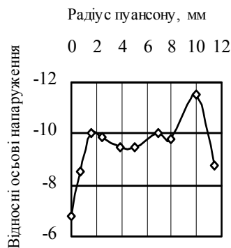
Рис. 5. Розподіл відносних осьових напружень по радіусу пуансона
