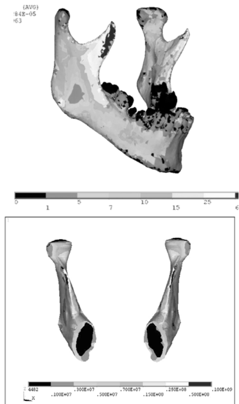
Рис. 4. Распределение эквивалентных по Мизесу напряжений в ИКМ нижней челюсти при функциональной нагрузке: а – общий вид; б – характерное сечение
