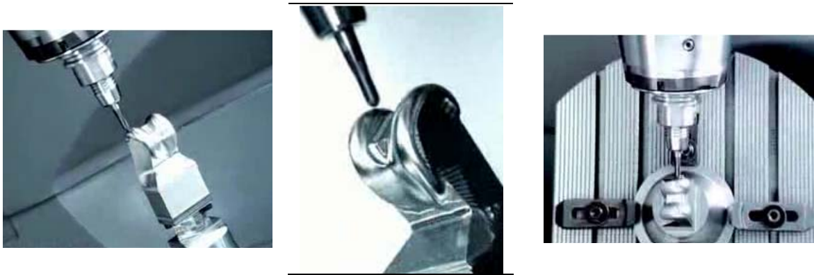
Рис. 1. Обробка штучного суглоба на 5-ти координатному верстаті з ЧПК DMU 50 фірми DECKEL MAHO
