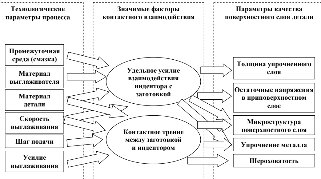
Рис. 1. Взаимосвязь технологических параметров процесса выглаживания при формировании параметров качества обработанной детали
