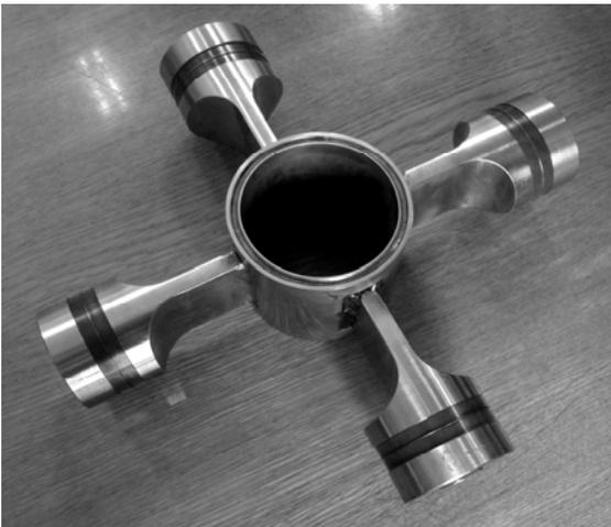
Рис. 1. Ультразвуковая кавитационная проточная камера с трубчатым вибратором
