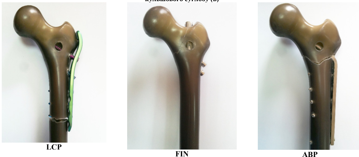
Рис. 6. Загальний вигляд моделей стегнової кістки з різними типами фіксаторів після випробувань на міцність
