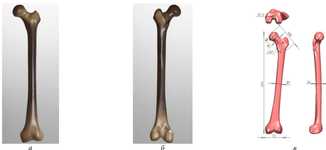
Рис. 1. Зовнішній вигляд синтетичної моделі стегнової кістки: а – вид спереду; б – вид ззаду; в - антропометричні параметри
